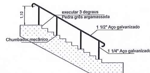
Detalhe do guarda-corpo - escadaria 02 (comprimento 5,0m - duplo)
